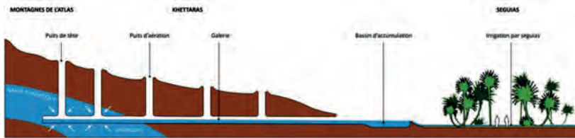
FIG. 1 – Schéma de captation et d'acheminement des eaux souterraines par le système de khettaras et de séguias , dessin M. Bennani.
